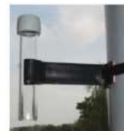
Figura 2: il campionatore aperto per il rilevamento (solo dal 16 ottobre 2018)
